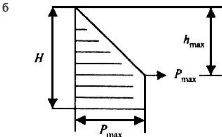
Рисунок Г.1 - Расчетные эпюры бокового давления бетонной смеси
